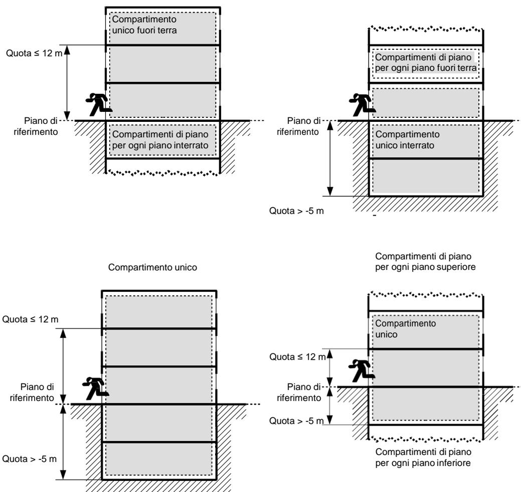
Illustrazione S.3-1: Esempi di compartimentazione multipiano, in sezione
