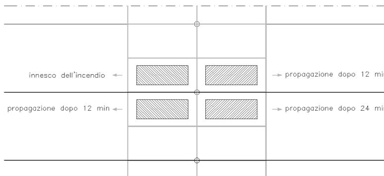
c) *Scenario S3: caratterizzato dall'incendio di 4 veicoli posti intorno ad una colonna. L'incendio si avvia da uno di essi, dopo 12 minuti si propaga a 2 veicoli, dopo ulteriori 12 minuti si propaga all'ultimo veicolo; uno dei veicoli deve essere un autoveicolo commerciale.*
