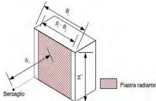
Illustrazione S.3-5 Schematizzazione della piastra radiante
