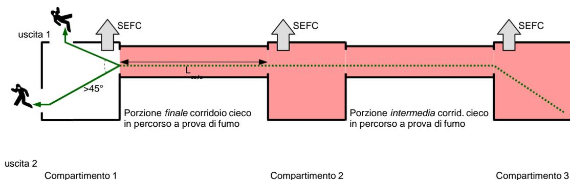
Illustrazione S 4-6 Esempio porzione di corridoio cieco in percorso a prova di fumo (in pianta)
