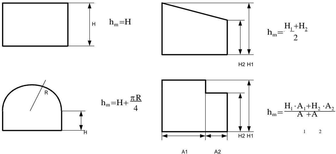
Illustrazione G.1-2: Esempi di determinazione dell'altezza media, in sezione
