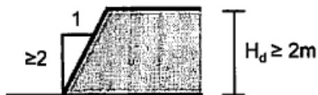
**Figura 1 - Caratteristiche geometriche di un dislivello a strapiombo**
